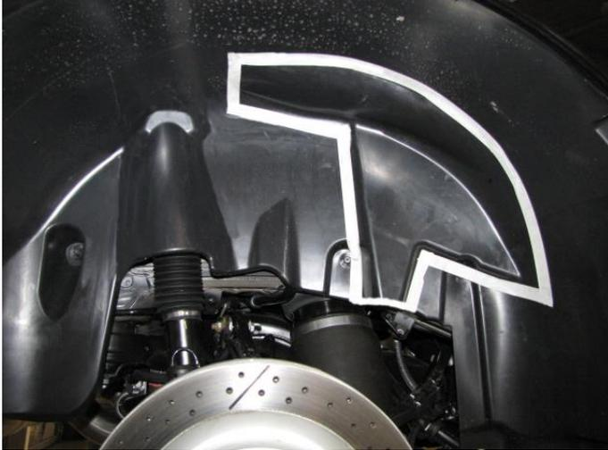
K131) Um eine ausreichende Freigängigkeit an Achse 2 herzustellen ist die Kunststoffverbreiterung der Radhauskante im Bereich der umgelegten Radhauskante auf eine Restdicke von 5mm zu kürzen.
